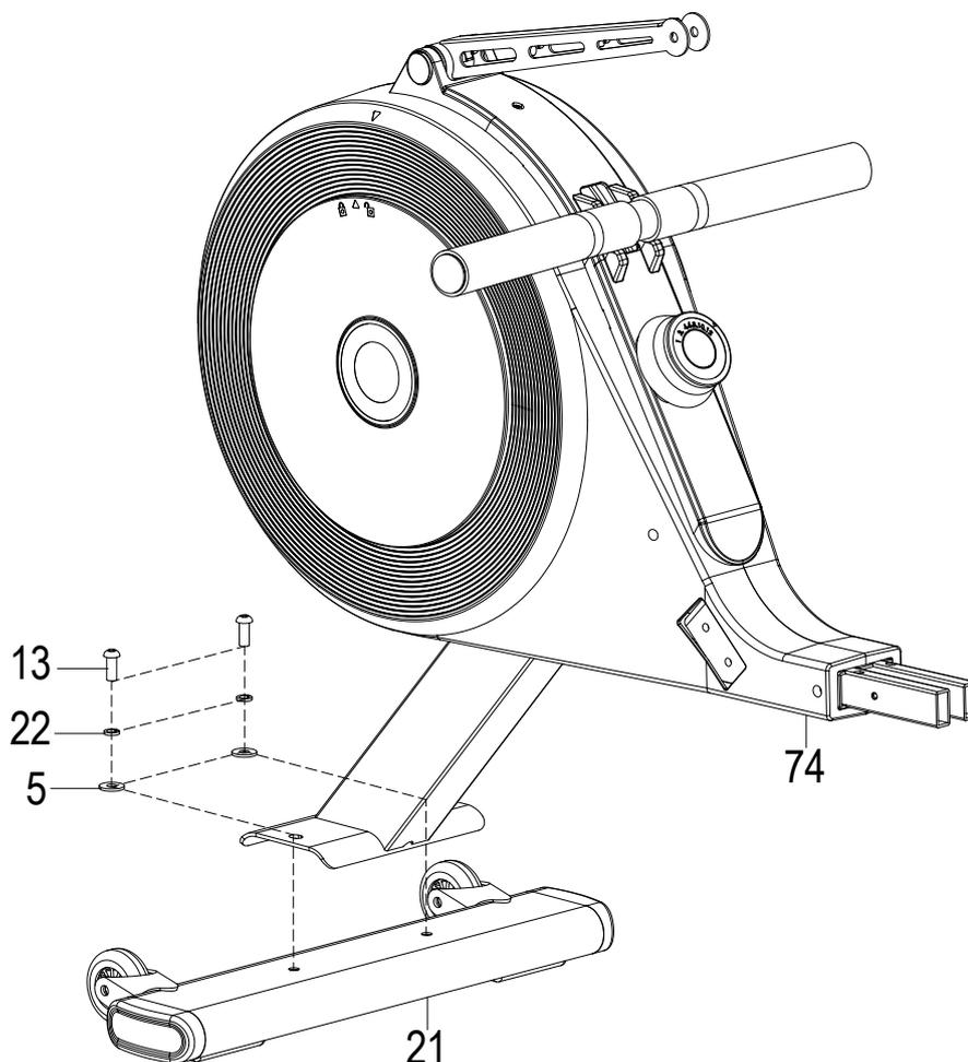
**Montaggio barra d'appoggio posteriore:**
