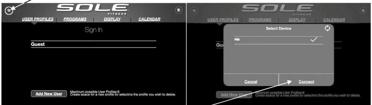
Dopo il rilevamento della console, premere su Connetti. Quando il dispositivo e la console sono sincronizzati, l'icona Bluetooth® sulla console si accende e si può quindi utilizzare l'interfaccia di Sole Fitness App attraverso uno smartphone o un tablet.
