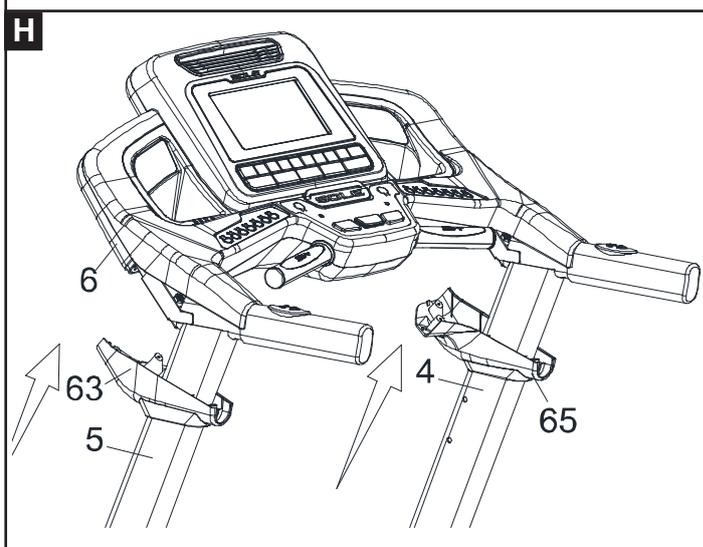
**I.** Fissare i coperchi sulle estremità dei montanti serrando dalla parte inferiore di ciascuno tre viti filettate **168** [ST3,5x12 mm], facendo riferimento all'illustrazione a lato; impiegare il giravite nella chiave **131** fornita in dotazione.
