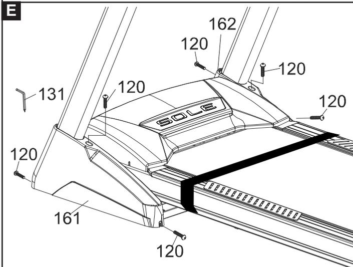
**E.** Abbassare i due rivestimenti copri-montante **161** e **162** e posizionarle allineandole ai fori di fissaggio delle clips.
