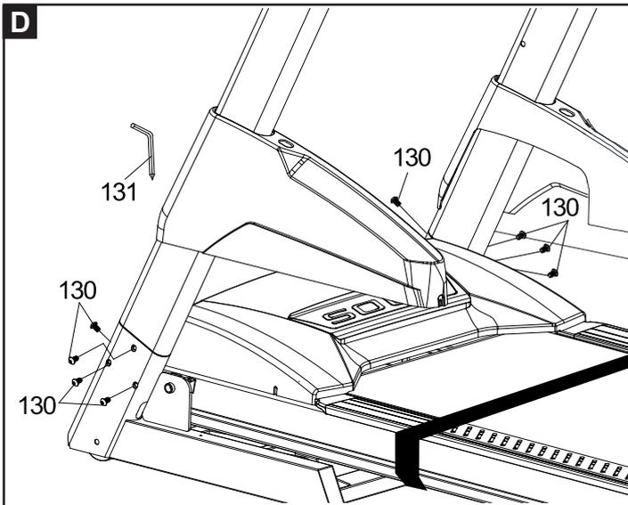
**D.** Fissare i montanti destro e sinistro alla base del telaio serrando ciascuno con quattro viti **130** [5/16" × 1/2"]; impiegare la chiave **131**.
