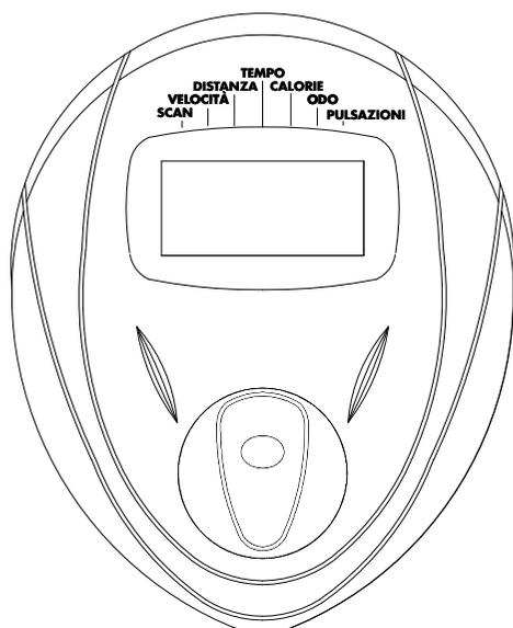
**AUTO ON/OFF:** Il computer si accenderà alla pressione del tasto o quando verrà rilevato un segnale di movimento dei pedali. Si spegnerà automaticamente dopo 4 minuti di inattività.
