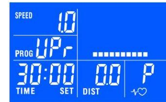
Programmieren Sie die Geschwindigkeit und die Inklination für jedes Segment mit ↑/↓ und ENTER.
