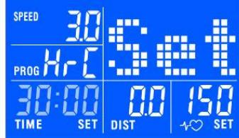
Presione START: la cinta correrá a una velocidad de 3 kph durante 2 minutos para calentar: Ajuste la elevación de manera manual.
