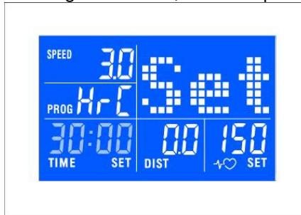
De loopband zal 2 minuten draaien met een snelheid van 3 km/u als opwarming: u kunt de inclinatie manueel instellen.
