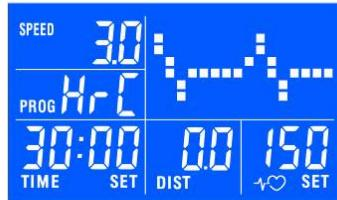
Programmieren Sie die Zielsetzung Pulsschlag (THR= Target Heart Rate) mit ENTER und ↑/↓ .
