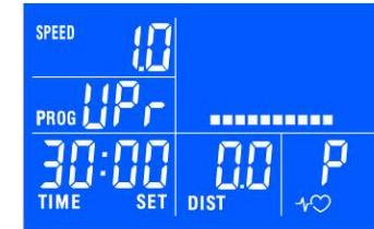
Use ↑/↓ para introducir velocidad y la inclinación para cada segmento y confirmar para ENTER.
