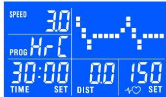
Use ↑/↓ buttons para introducir la THR (Target Heart Rate) deseada y confirme con ENTER
