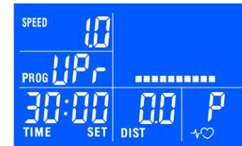
Programmare la velocità e l'elevazion per ogni segmento con  $\uparrow/\downarrow$ , e premendo ENTER.
