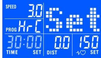
Drücken Sie auf auf START um mit dem Training anzufangen. Das Laufband wird 2 Minuten mit einer Geschwindigkeit von 3 km/Stunde bewegen (zum aufwärmen), die Steigung (Inklination) können Sie manuell ändern.
