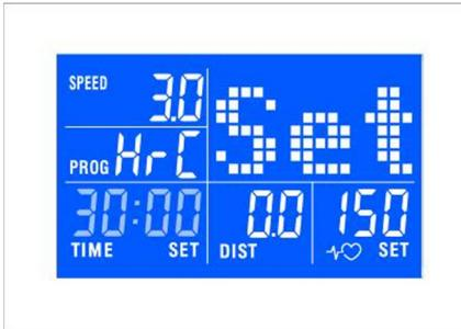
Presione START: la cinta correrá a una velocidad de 3 kmh durante 2 minutos para calentar: Ajuste la elevación de manera manual.
