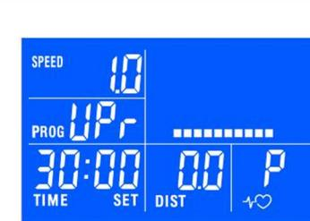
Programmare la velocità e l'elevazion per ogni segmento con  $\uparrow/\downarrow$ , e premendo ENTER.
