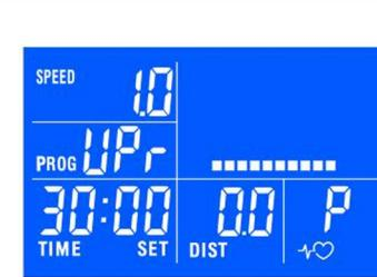
Use ↑/↓ para introducir velocidad y la inclinación para cada segmento y confirmar para ENTER.
