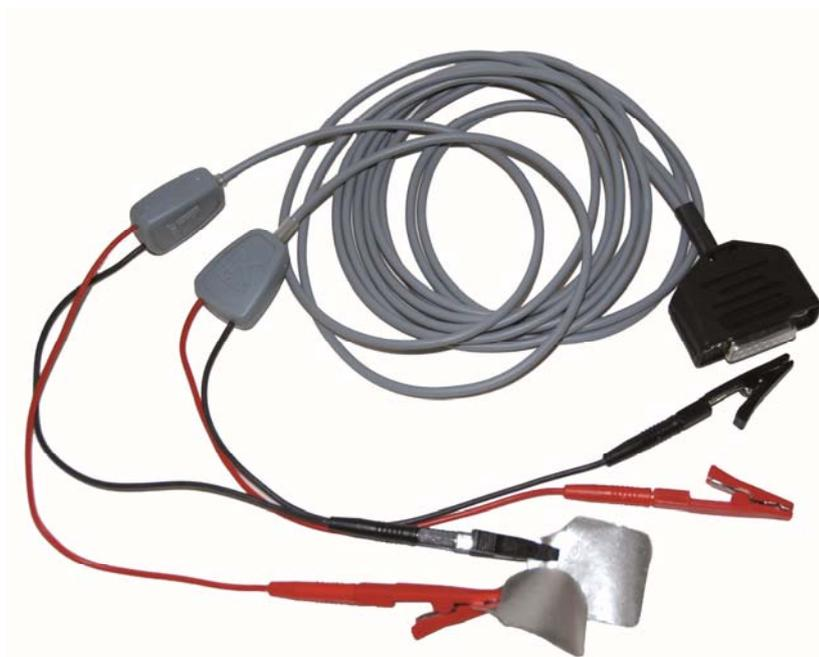
Bodycomp MF Hexa è dotato di cavo paziente tetra-polare per misure total body con pinzette a coccodrillo di colore rosso e nero.
