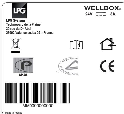
Etichetta d'identificazione "tipo" soggetta a modifiche per tenere conto degli sviluppi dell'apparecchio e del tipo di Wellbox. L'etichetta posta nella parte inferiore della Wellbox indica la versione approvata.
