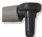
Boquilla (salida de aire) existente en las líneas de los conectores
