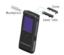
Per assicurare la precisione delle misurazioni e l'assenza di residui, attendere 3 minuti prima di effettuare un nuovo test. Sostituire il boccaglio e il tubetto ad ogni test.
