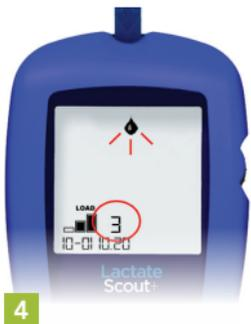
Il numero corrispondente alle concentrazioni di lattato registrate in ogni fase dello step test è correlato al numero dei test eseguiti. Il conteggio dei valori rilevati nel test avviene separatamente per ogni fase dello step test ed è automaticamente visualizzato sul display a destra del simbolo che si riferisce alla rispettiva fase di step test (4). A ogni step di carico della relativa fase di step test ("LOAD") viene destinato un test.
